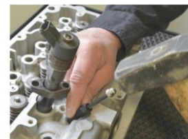
OM3790 Trekker voor gloeibougiespitsen / Kit d'extraction d'électrode de bougies de préchauffage M8 - M9 - M10 x 1,0 - M10 x 1,25. PSA-FORD-MAZDA-SUZUKI-TOYOTA-VOLVO
