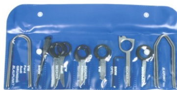
BGS8011 Demontageset voor radio's Set de démontage pour autoradios
